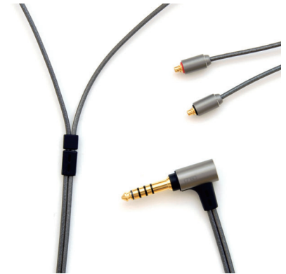
ict_04_b14m_120 4.4 5極プラグ - mmc(l/r) 6N + 銀鍍金 4N銅 pvc ジャケット 4.4-5p:金メッキ仕上げ (L型) mmcコンタクト:金メッキ仕上げ チタン 素地 プラグキャップ 長さ:1.2m jan:4534165013569
